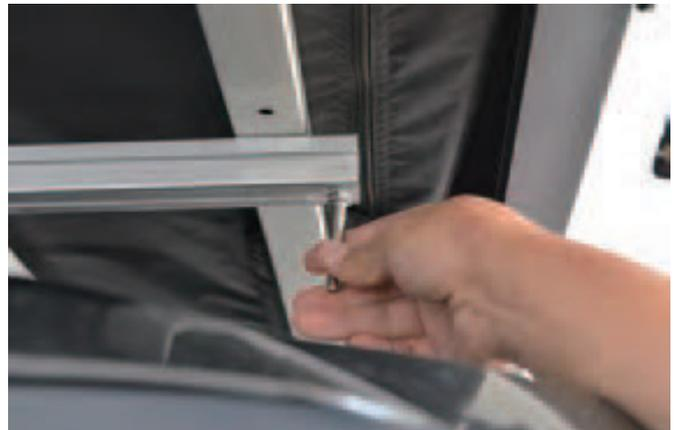
5. Coloca los soportes con forma de “U” recubiertos de goma bajo las barras de carga de manera que los tornillos M8 que colocamos en el paso anterior pasen a través de los agujeros. Asegurar usando la arandela plana, seguida de la arandela de presión, seguidamente realizar el apriete con el pomo roscado con forma de estrella.
