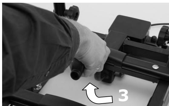
Maintenez le tube-en-U avec une main pour éviter une chute du porte-vélos. Pour déverrouiller pousser le levier du mécanisme à bascule avec l'autre main vers le bas (3). Vous arrivez à basculer tranquillement votre porte-vélos maintenant.
