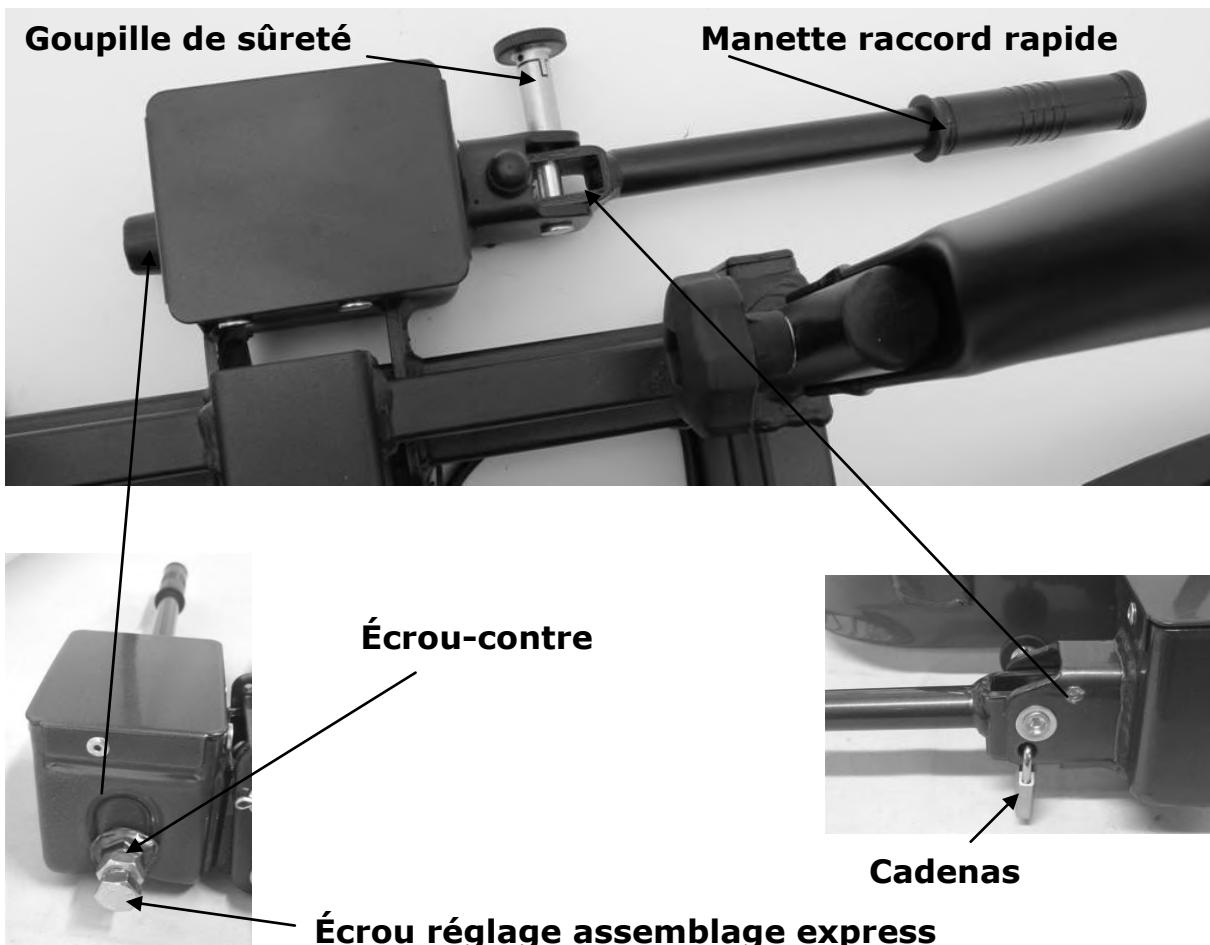
Cet assemblage express contient une partie fixée au porte-vélos et un levier. A l'aide de ce levier, l'assemblage express peut être débloqué (ouvert) ou bloqué (fermé).
