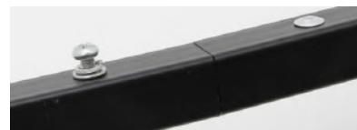
Monter le support de rail de lumière sur le fond du châssis de base au moyen de deux boulons et rondelles M5x35.
