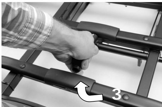
Maintenez le tube-en-U (ou vélo) avec une main pour éviter une chute du porte-vélos. Pour déverrouiller pousser le levier du mécanisme à bascule avec l'autre main vers le bas (3). Vous arrivez à basculer tranquillement votre porte-vélos maintenant.
