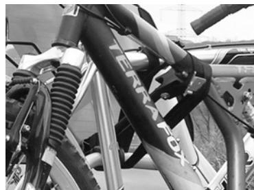
**Attachez les bicyclettes avec la ceinture de sécurité longue** en la posant à travers les cadres des bicyclettes et autour de l'étrier. Serrez ensuite cette ceinture de sécurité fermement.
